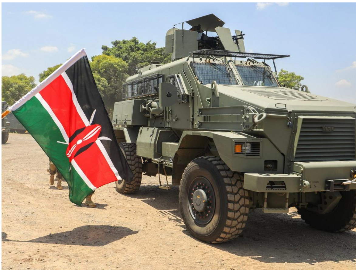
Uno de los blindados del Ejército de Kenia, capaces de resistir la explosión de minas terrestres y trampas.
