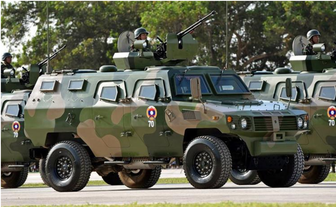
Vehículos blindados de origen chino 4x4 Tiger (ZFB-05), capaces de transportar a 9 soldados y una tripulación de dos personas. Llevan torreta tipo góndola con ametralladora pesada CS/LM3 de 12,7x99 mm.
