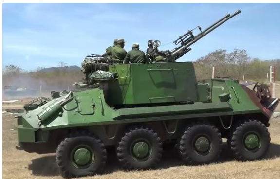
Blindado BTR-60 adaptado localmente con montaje antiaéreo Type 76 de 37 mm. de origen chino.
