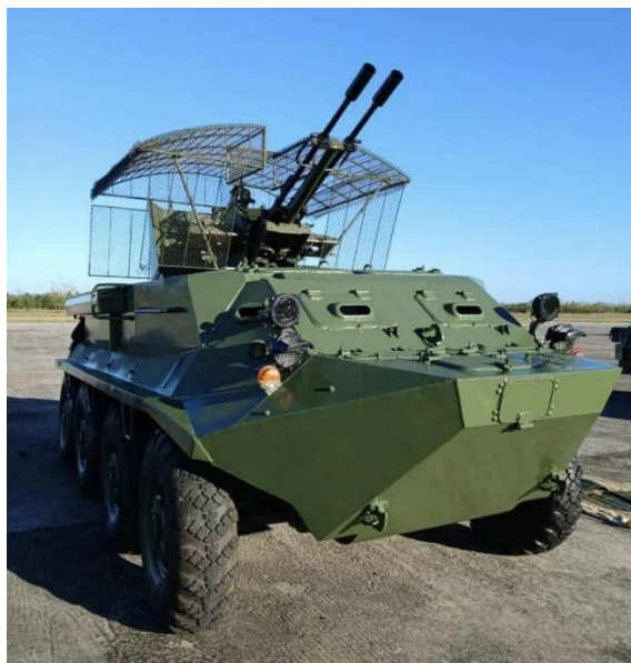
Blindado BTR-60 adaptado localmente con montaje antiaéreo ZU-23 y jaula antidrones.
