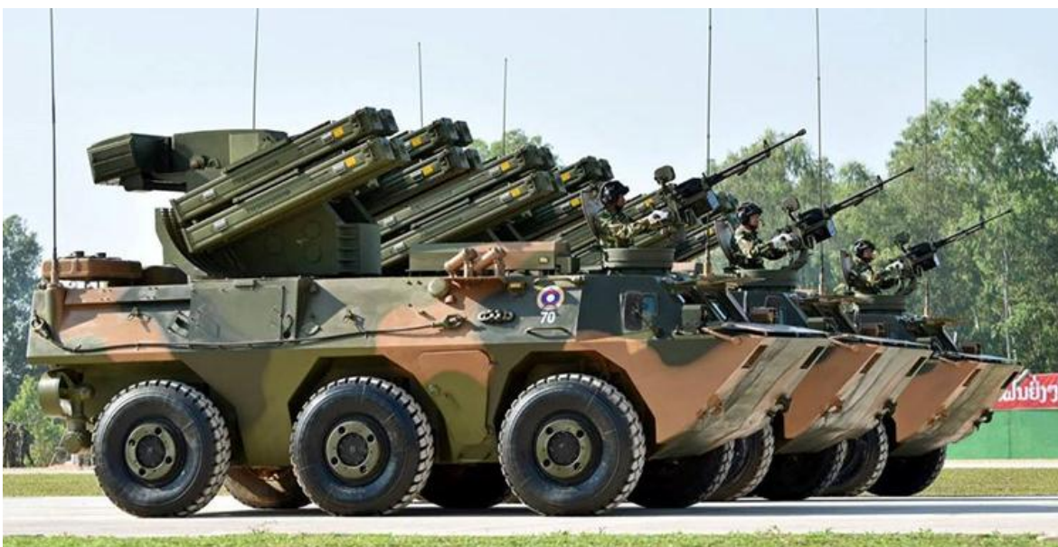
Sistema antiaéreo misilístico de origen chino Yitian, sobre el chasis del vehículo blindado de combate 6x6 WMZ551.
