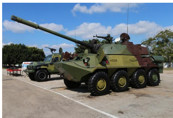
Vehículo BTR-100, adaptación cubana montando una torre de T-55 con cañón de 100 mm. en blindado BTR-60.
