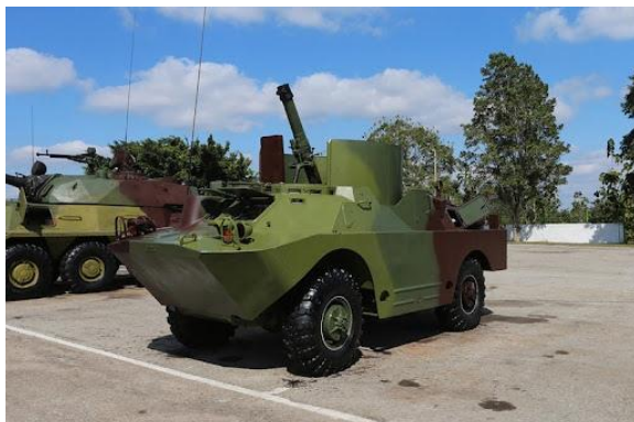
Blindado de origen ruso BRDM-2 adaptado localmente montándole un mortero de 120 mm.
